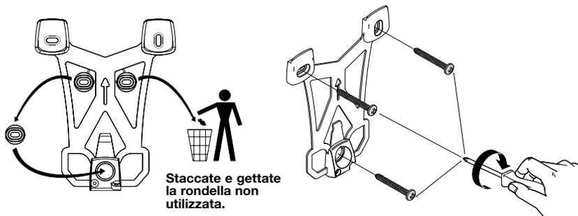
4. Prendete la maschera di foratura del magnete antirimozione in dotazione nel sacchetto degli accessori e inseritela sul supporto di fissaggio.
